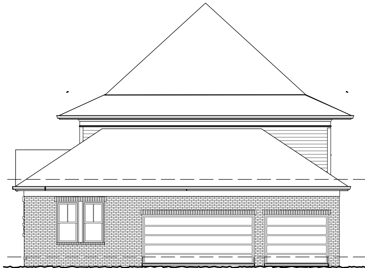
2 REAR ELEVATION Scale: 1/8" = 1'-0"
